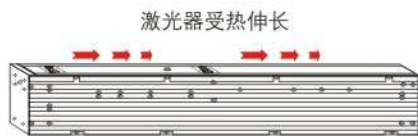
激光器受热伸长 激光器产生的形变应该如上图所示
